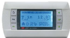
Halbgraphisches Bedienelement mit Multifunktionsstasten und dynamischen Anzeigesymbolen (Mod. 081-211).
